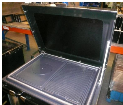
Figure n°17 - Protection sous la plaque vitrocéramique
