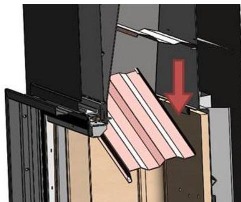
Figure n°21 - Démontage du déflecteur inférieur Inca
