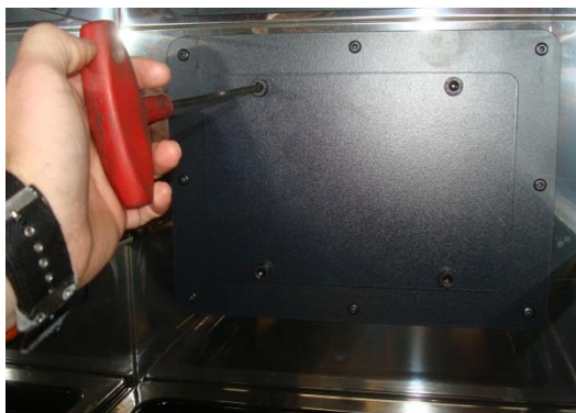
Figura n°20 - Accès pour le nettoyage de la sortie de fumée
