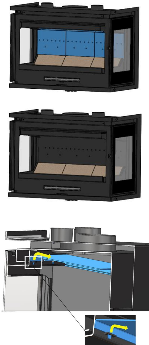
Figure n°9 - Démontage du déflecteur acier
