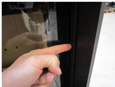
Pour refermer la porte il faut la ramener contre le corps de chauffe et appuyer fortement sur celle-ci jusqu'à entendre le clic du système de verrouillage. Si vous n'entendez pas le clic et que la porte ne se verrouille pas, il y a peut-être trop de pression sur le joint, il faut alors lever la porte en vertical en maintenant la porte fermée latéralement avec une main, lorsque la porte va se soulever il n'y aura plus de pression sur le joint et la porte se verrouillera sans effort.
