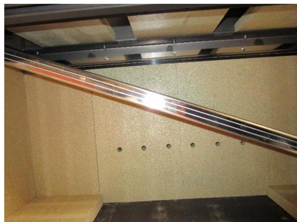
Pour placer la grande chicane, il faut au préalable ôter la brique de vermiculite de côté droit, ensuite introduire la chicane en biais dans l'appareil (renfort en inox vers vous), la poser sur le dessus de la brique de côté gauche et la redresser à l'horizontale avant de l'introduire dans la gorge en inox placée sur le dos de l'appareil. La faire glisser ensuite vers la droite pour qu'elle repose également sur la brique de côté droit, laquelle peut être remplacée à ce moment.
