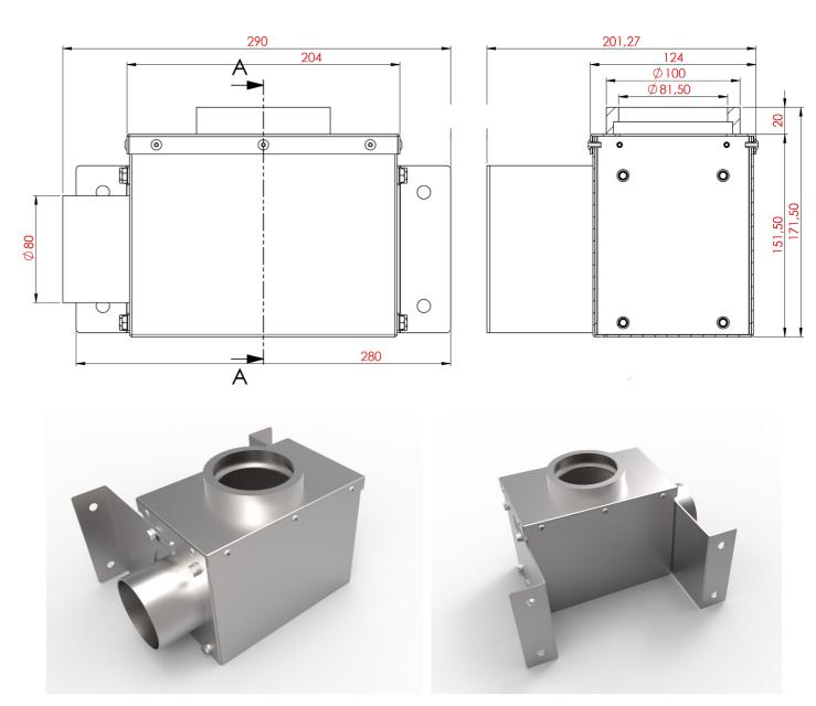
Chaque "MINI FUSION IN MOBILE" sera fourni avec une boîte à fumées et une gaine M1 permettant le raccordement à l'évacuation des fumées.
